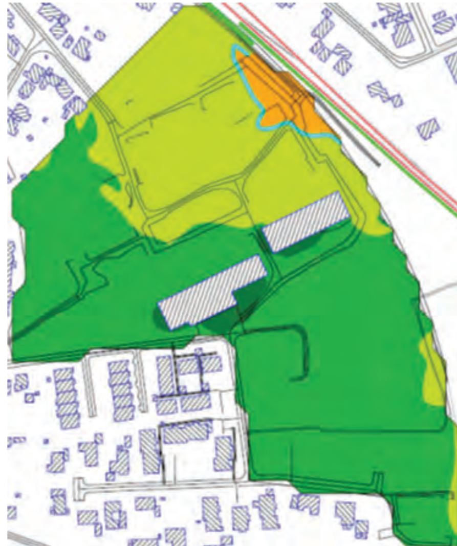
Støj fra jernbanen med støjskærm langs banen 12
